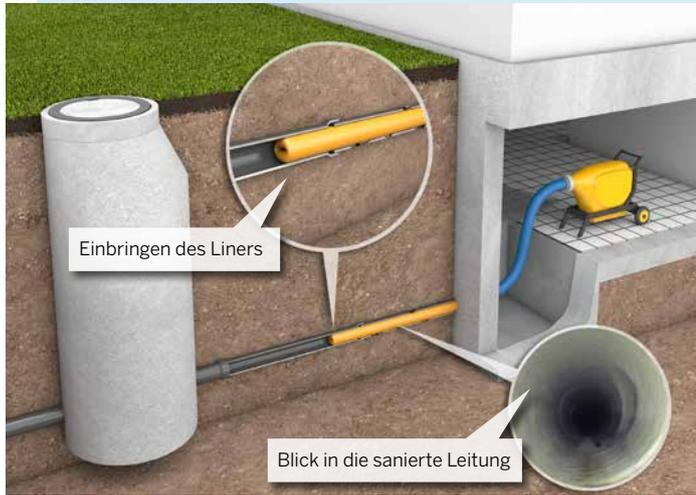
Renovierung durch Schlauchlining (sehr häufig eingesetztes Verfahren, da sehr flexibel und bogengängig)
